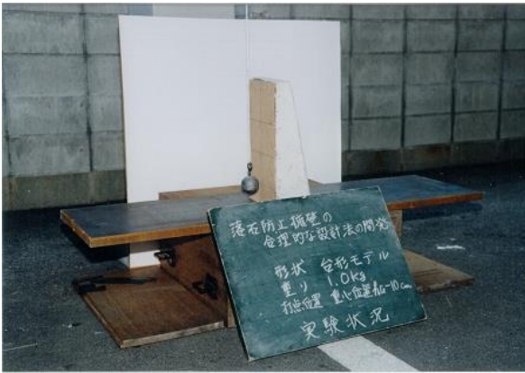
落石防護擁壁の模型実験
