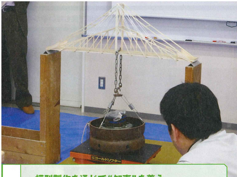
橋梁模型コンテストの 載荷試験。40kgを上限 に載荷重量を競う (写真:高知工業高校)
